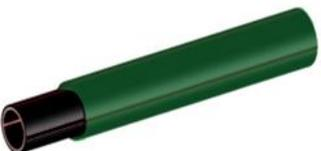
Труба двустенная ТПДС Эко-Лайф СЗ 110/90 мм, труба в трубе, внутренняя труба 90 мм с внутренним токопроводящим покрытием и барьерным слоем, маркировка взрывозащиты Ex, SDR11, внешний слой ПЭ100, внешняя труба диаметром 110 мм, ПЭ100, прямой хлыст 6 м
