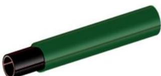
Труба двустенная ТПДС Эко-Лайф СЗ 75/63мм, труба в трубе, внутренняя труба 63 мм с внутренним токопроводящим покрытием и барьерным слоем, маркировка взрывозащиты Ex, SDR11, внешний слой ПЭ100, внешняя труба диаметром 75 мм, ПЭ100 намотка в бухту по 33 м
