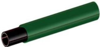
Труба двустенная ТПДС Эко-Лайф СЗ 63/50 мм, труба в трубе, внутренняя труба 50 мм с внутренним токопроводящим покрытием и барьерным слоем, маркировка взрывозащиты Ex, SDR11, внешний слой ПЭ100, внешняя труба диаметром 63 мм, ПЭ100 намотка в бухту по 33 м
